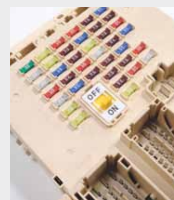
Pametno: glavni prekidač u kutiji osigurača sprečava pražnjenje akumulatora kad se Ceed dulje ne koristi
