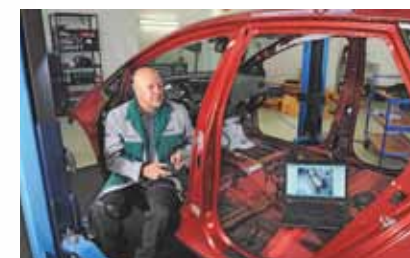
DEKRIN stručnjak provjerava endoskopom karoseriju Kije Ceed
