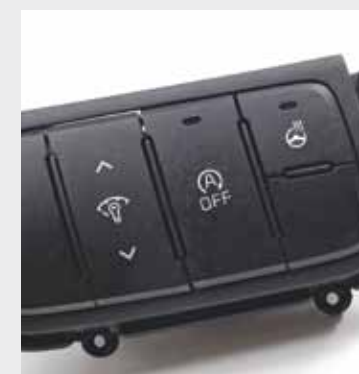
Skriveno iznenađenje za udobnost: prekidač za ugodno grijanje kola upravljača skriva se iza kola upravljača
