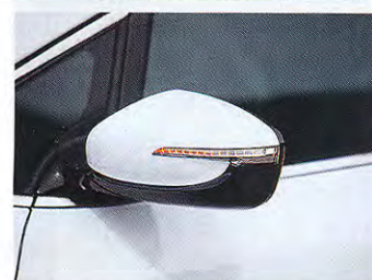
S odabirom paketa opreme EX Style bočni žmigavci se s blato-brana sele na retrovizore
