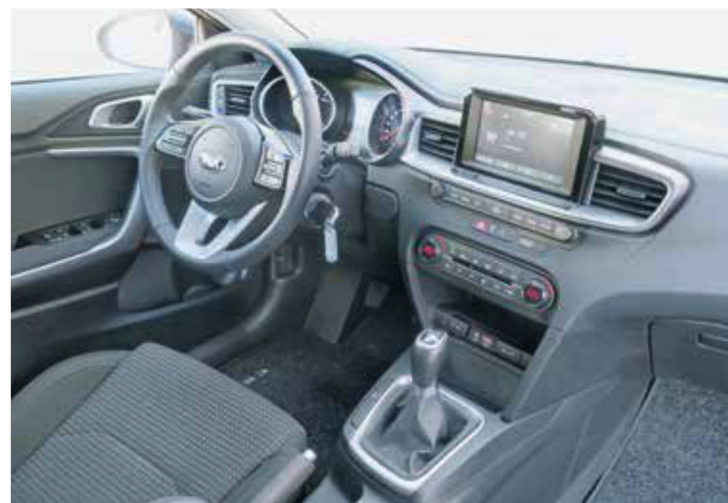
Notranjost odlikujeta pregledna zasnova analogno-digitalnih merilnikov in preprosto upravljanje sistemov s klasičnimi gumbi ali dotiki na zaslonu.
