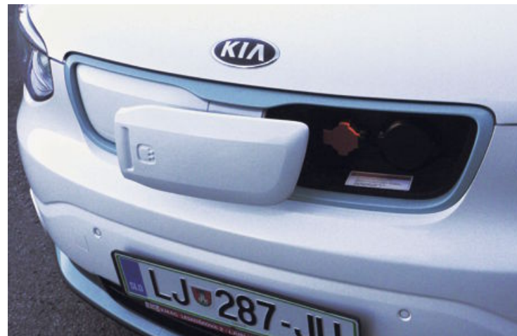
Vtičnici za hitro in običajno polnjenje sta preprosto dosegljivi v sprednjem delu. Rok si pri odpiranju (iz kabine) in zapiranju z zgolj rahlim potiskom ne bi smeli umazati.
