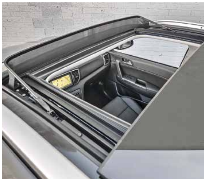
Deflektor krovnog prozora uveliko smanjuje kovitlanje vazduha u kabini
